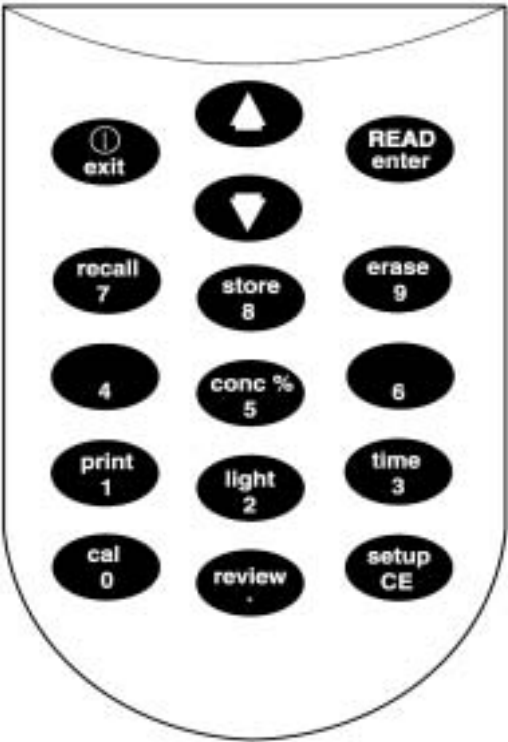
图 2 sension8 溶解氧仪的键盘
