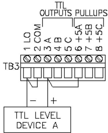
**图 2-7 内部供电逻辑操作的 TTL 输出连接**
