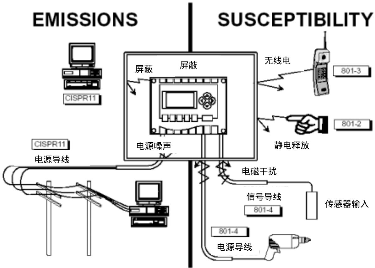
图 1-1 EMI/RFI 免疫特性示意图
