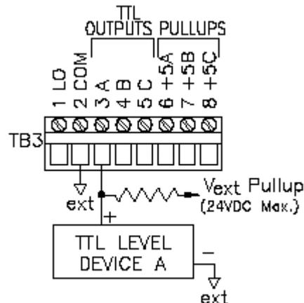
**图 2-8 外部供电逻辑操作的 TTL 输出连接**
