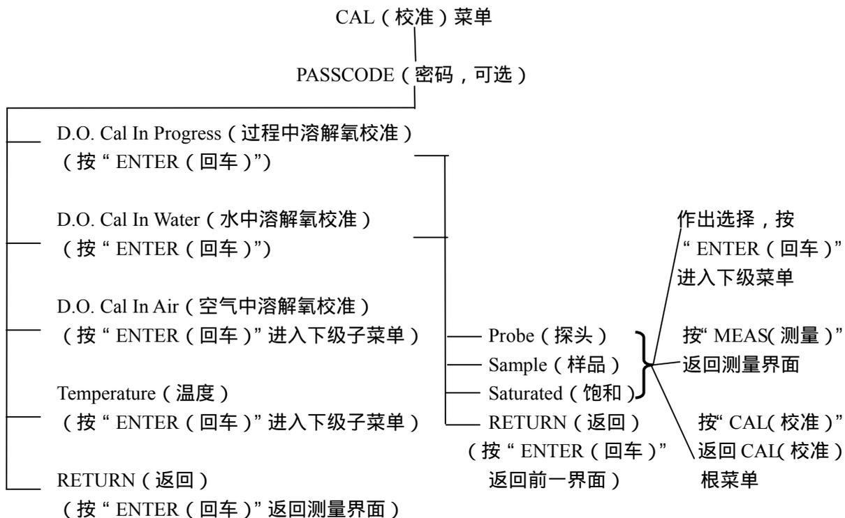
图 3-2 CAL (校准) 菜单结构 (续)
