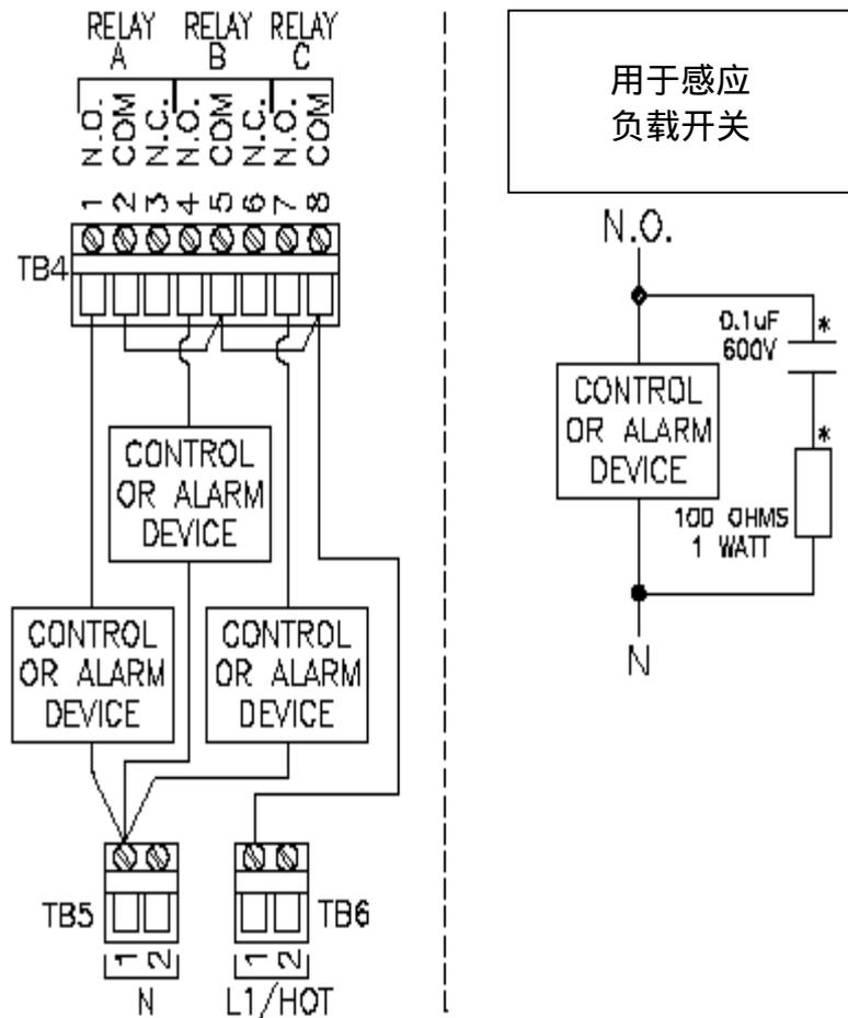
图 2-4 连接控制/报警装置到机电继电器
