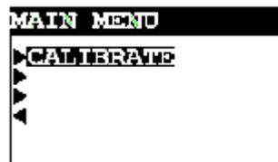
使用上下键显示以下菜单，根据需要分别选择不同的菜单，从左至右分别表示校正、配置及测试/维护菜单，其中校正包括：传感器、温度、模拟输出的校正；配置包括：模拟输出 1、模拟输出 2、继电器 A、B、C、D、密码保护、温度、压力单位、盐度单位、语言及传感器配置；测试/维护菜单包括：状态、模拟输出保持、过载重置、模拟输出 1、模拟输出 2、继电器 A、B、C、D、EPROM 版本、选取择 SIM、SIM 传感器、重置配置及重置校正。
